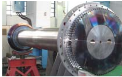
Рис. 7. Муфта ZCF с промежуточным валом
