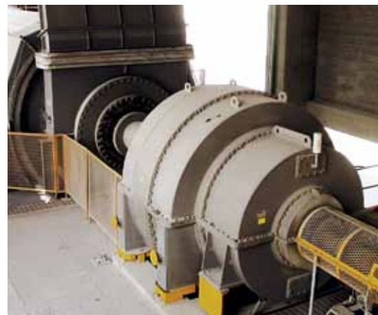
Вид в сборе редуктора CPU и внешних муфт
