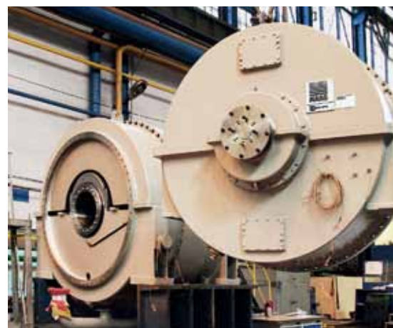
Две ступени редуктора MAAG CPU
