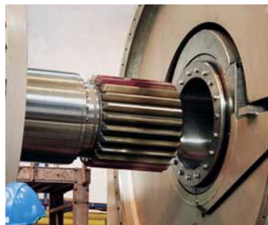
Установка солнечной шестерни второй ступени
