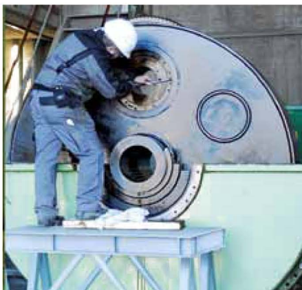
Рис. 1. Первая генеральная инспекция планетарного редуктора P2U3 производства FLSmidth MAAG Gear на предприятии после 37 лет (примерно 200 тыс. ч) работы
