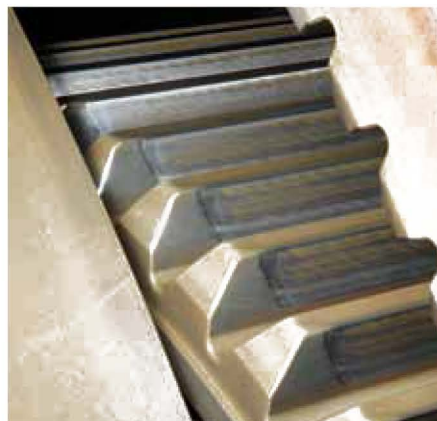
Рис. 2. Оригинальный рисунок от зубошлифовального инструмента, видимый на поверхности сателлитов второй ступени
